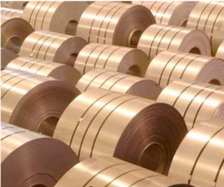
Figura 5.10 – Foto do estoque de produto em elaboração de bobinas laminadas a frio.
