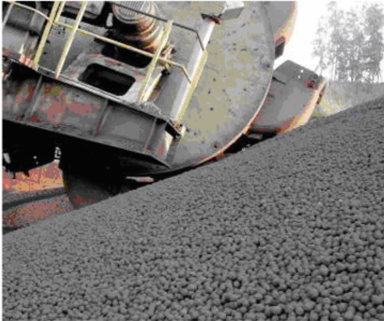
Figura 4.2- Foto da matéria prima (pelota) sendo retirada da pilha para abastecimento do Alto Forno.
