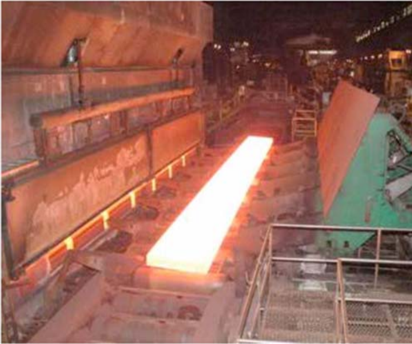
Figura 4.4 – Foto da placa já reaquescida na entrada do laminador desbastador rougher.
