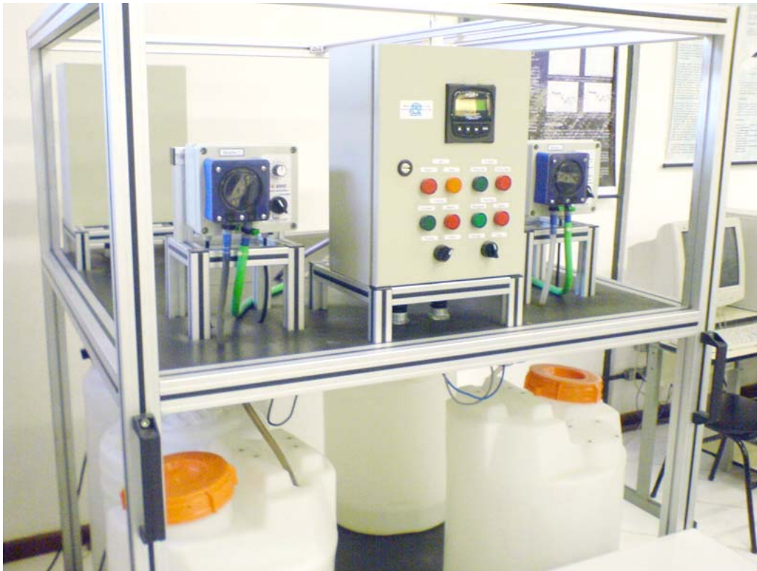
Figura 4.2: Foto frontal da planta piloto de neutralização de pH .
